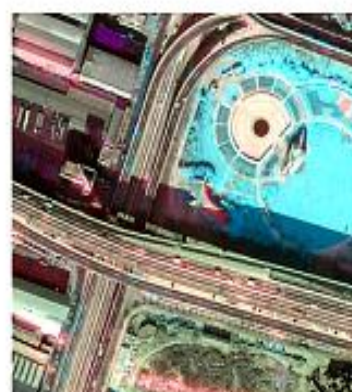
(c) 基于滤波器组的图(a)图(b)的航空影像融合(多源、多时相、多平台)
