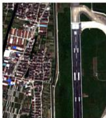
Quickbird Band3~Band1合成多光谱影像 (空间分辨率为2.44米, 升采样后为0.61米)
